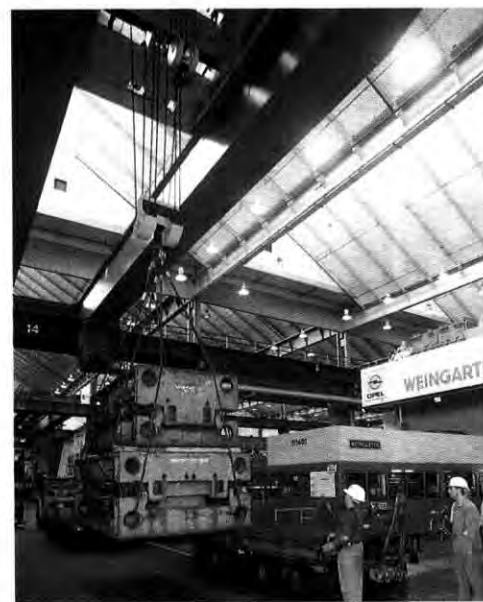
Hält er oder hält er nicht, das ist hier die Frage: Der Kran bei der Lastprobe
