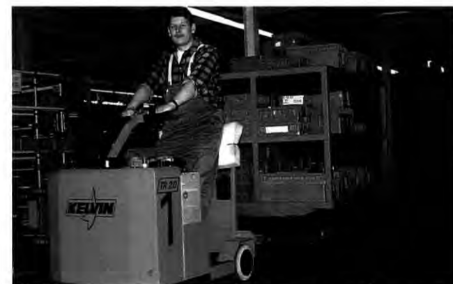
Kanban statt Einbahn: Linienversorgung mit Kleinteilbehältern
