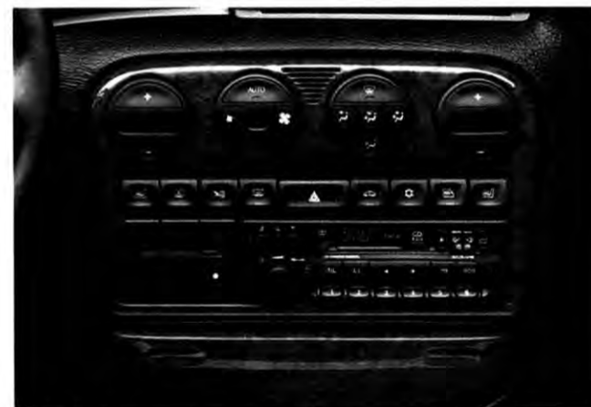
Eiskalt: Die Klimaautomatik wird elektronisch geregelt
