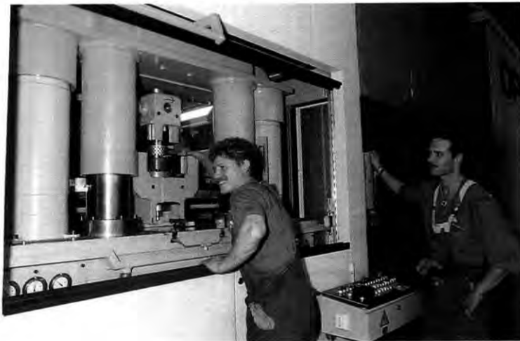
Schneidige Technik: Die „fliegende Schere“ schafft 120 Teile pro Minute
