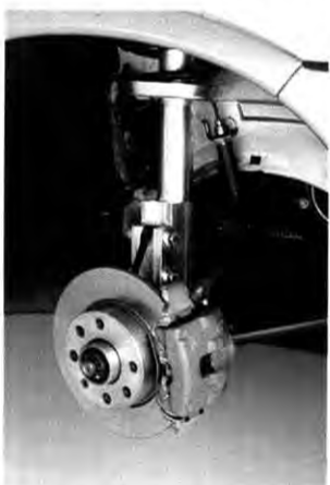
Diät: Bremsscheiben und Stoßdämpfergehäuse aus Alu
