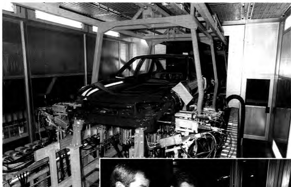
Volle Kanne: 65 Düsen versprühen 1 Liter Wachs in die Hohlräume
