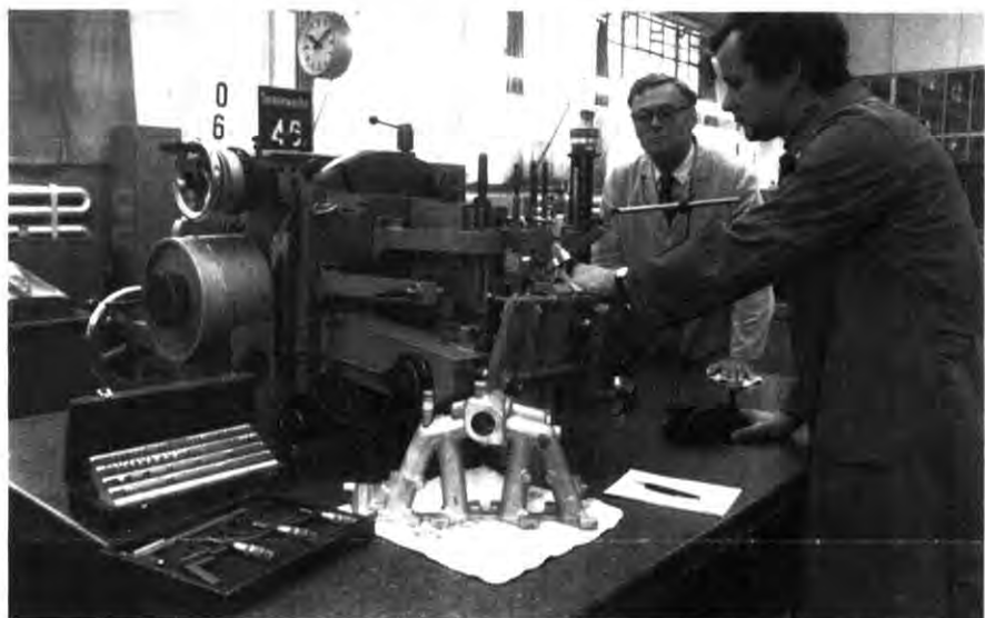
Das Vermessen einer Kontrollvorrichtung für Saugrohr. Meister Erich Steinbrecher (hinten) und Mitarbeiter Eduard Facchinetti beim Überprüfen der nach Zeichnung angegebenen Maßtoleranzen im Meßraum des Werkzeugbaues.
