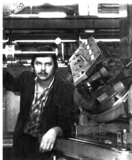
Mitarbeiter Werner Eckert bohrt auf einem Lehrenbohrwerk die genauen Abstände und Winkelstellungen an einer Bohrvorrichtung für Zylinderköpfe, die im Motorenbau Verwendung findet.
