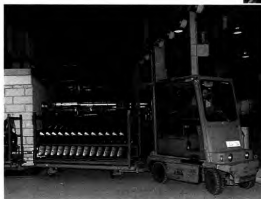
Verschleppt: Ein voller Wagenzug fährt auf Knopfdruck vor und wird vom herbeigefunkten Fahrer abtransportiert
