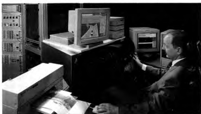
Simuliert: Mit Hilfe eines Elektronenhirns können Fahrbefehle hinter einem Original-Cockpit via Lenkrad, Schalthebel sowie Pedalerie erteilt und das Fahrverhalten über einen Bildschirm überprüft werden.
