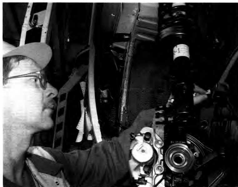
Hochzeitsvorbereitung: In der Fertigmontage wird die Käfigmutter eingesetzt
