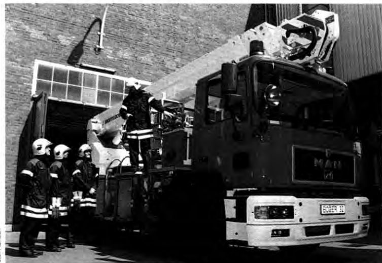
Brandneu: Der Leiterwagen mit seiner 32 Meter-Teleskop-Mastbühne
