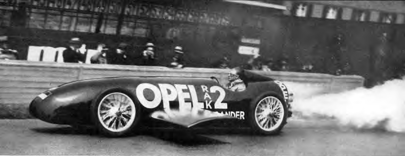
DER OPEL - RAKETENWAGEN „RAK 2“ mit Fritz von Opel am Steuer während seiner Fahrt auf der Avus am 23. Mai 1928. Die elektrisch gezündeten Pulverraketen lassen einen langen
