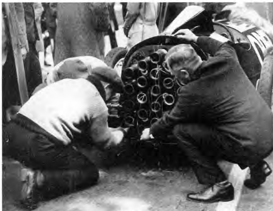
DIE KABEL zur elektrischen Zündung der Pulverraketen des Opel-Raketenwagens „Rak 2“ werden hier vor dem Start angeschlossen
