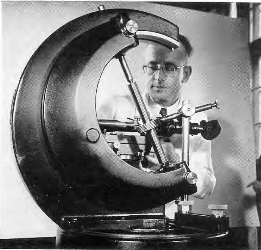
IM MESSRAUM DER INSPEKTION steht neben zahlreichen Meßgeräten das Zahnrad-Prüfgerät, mit dem die Teilungsgenauigkeit eines Zahnrades gemessen wird. Bei einem hochwertigen Lehrzahnrad dürfen die Abweichungen nur einige Tausendstel Millimeter betragen
