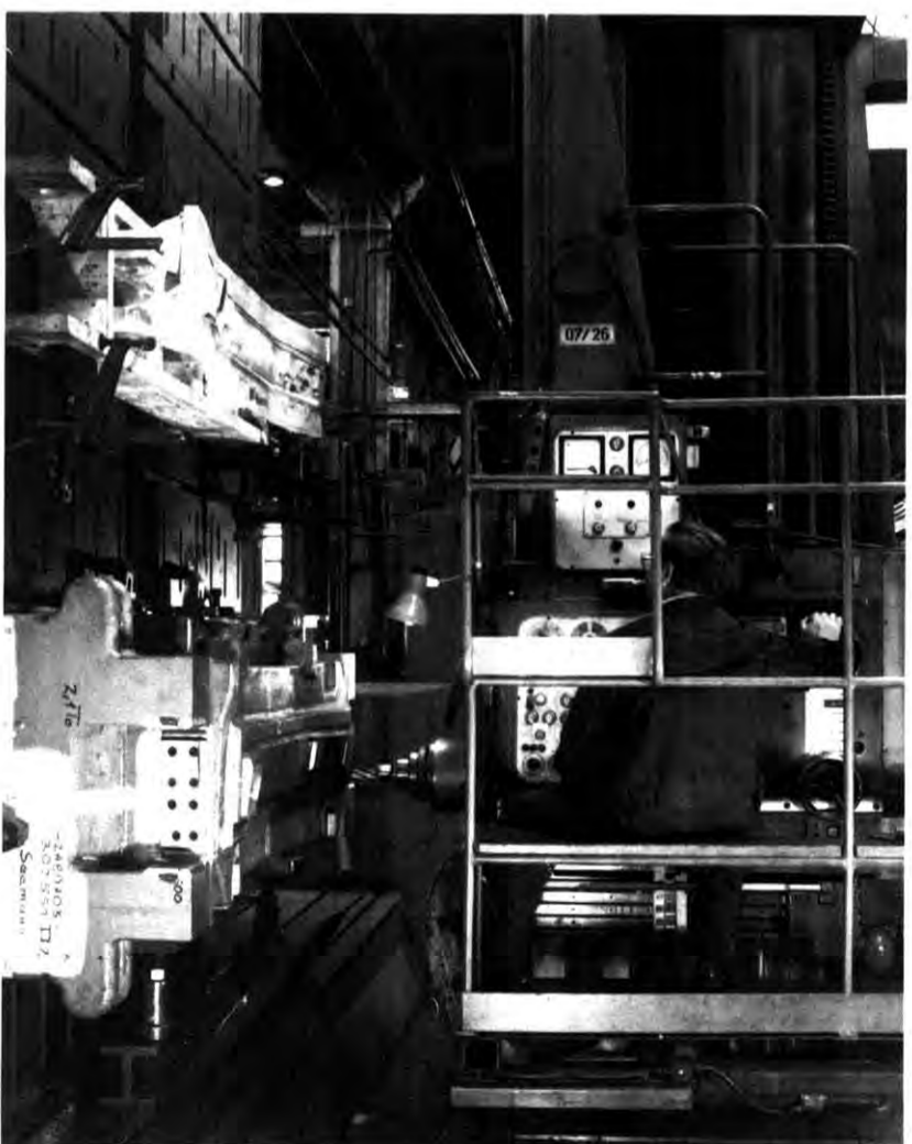
Beim Kopierfräsen an der Kopierfräsmaschine erkennt man hier Mitarbeiter Werner Friedrich.
