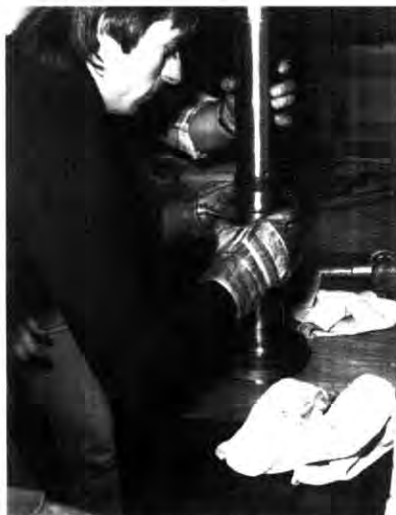
Seminar-Teilnehmer W. Dechent beim Warmziehen eines Wälzlagers.
