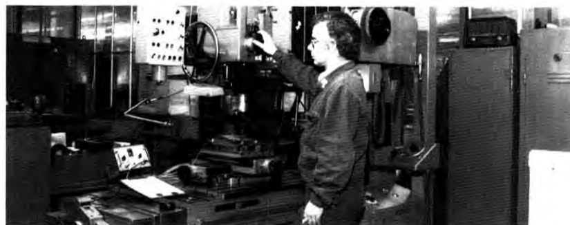
Mitarbeiter Friedrich Müller beim Schleifen auf der Koordinaten-Schleifmaschine. Hier geht es um Toleranzen, die bei \pm 0,005 mm liegen.
