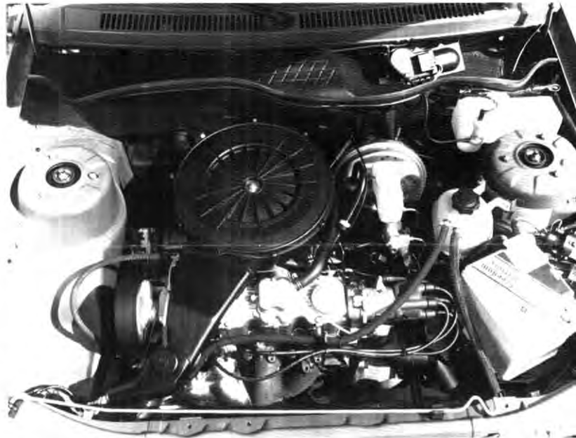
Der neue 1,6 Liter S-Motor, der von nun an auch für alle Kadett-Modelle lieferbar ist. Die Höchstgeschwindigkeit liegt bei 170 km/h.
