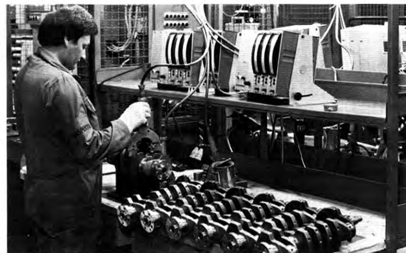
Vor den zwölf modernen Prüfständen des Motorenwerkes läuft eine Transportbahn, von der die Motoren automatisch in freigewordene Test-Stände gleiten. Die erforderlichen Anschlüsse auf dem Prüfstand – für Treibstoff, Kühlwasser und Öl – werden zum Teil automatisch hergestellt. Bei mittleren Drehzahlen läuft jeder Motor 20 Minuten zur Probe, ehe er dann von einem Inspektor abgenommen wird.
