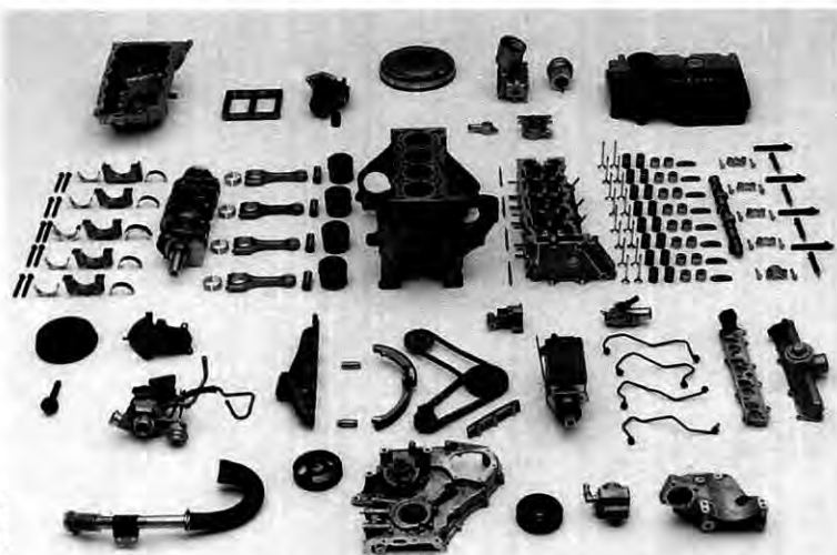
Premiere: Opel hat als erster Autobauer einen Pkw-Serien-Turbodiesel entwickelt, der Vierventiltechnik und Direkteinspritzung kombiniert
