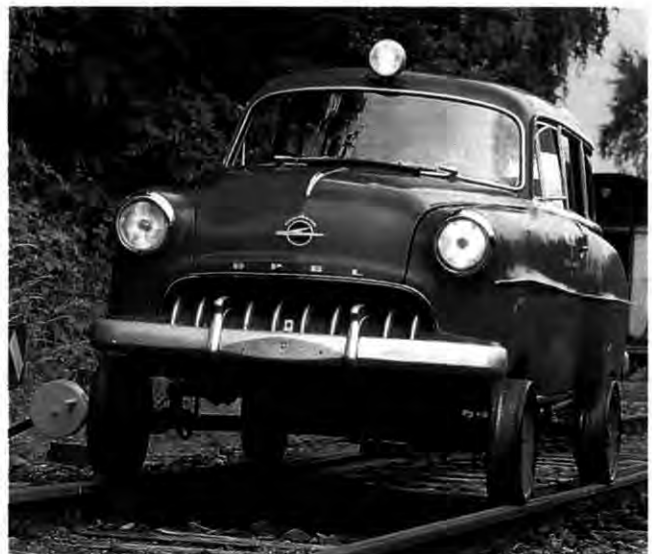
Bahn-Tuning à la Olympia: Höhergelegt und schmale Stahlräder
