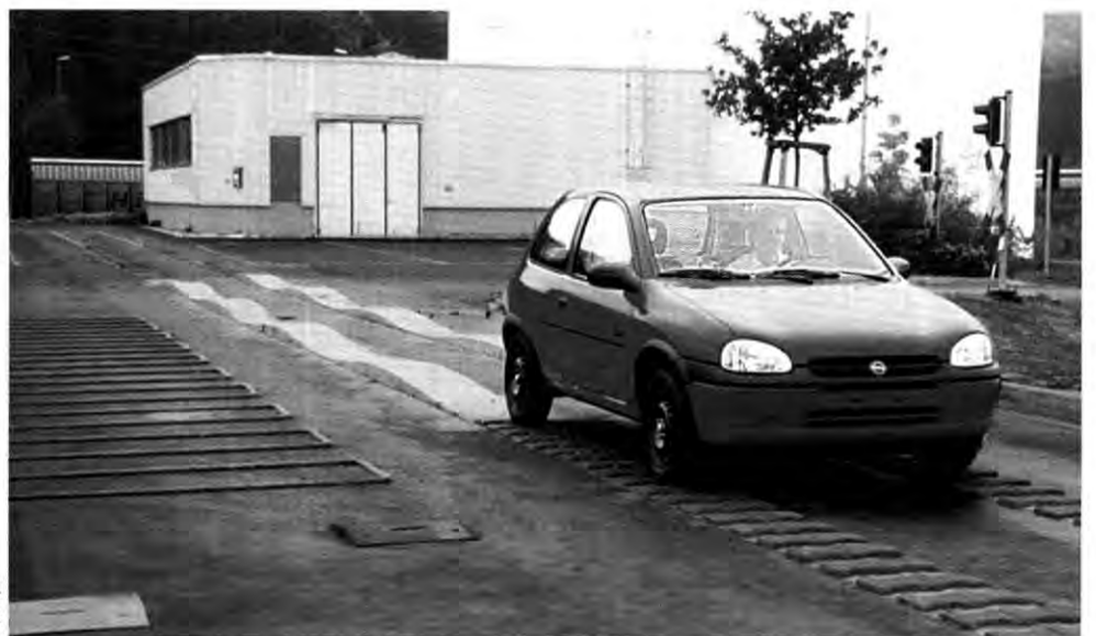
Hörtest: Fährt der Corsa über die Teststrecke, bleibt den Technikern kein Geräusch verborgen
