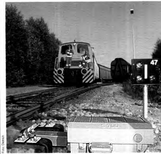
Wie am Schnürchen: Die Loks haben jetzt Funkfernbedienung
