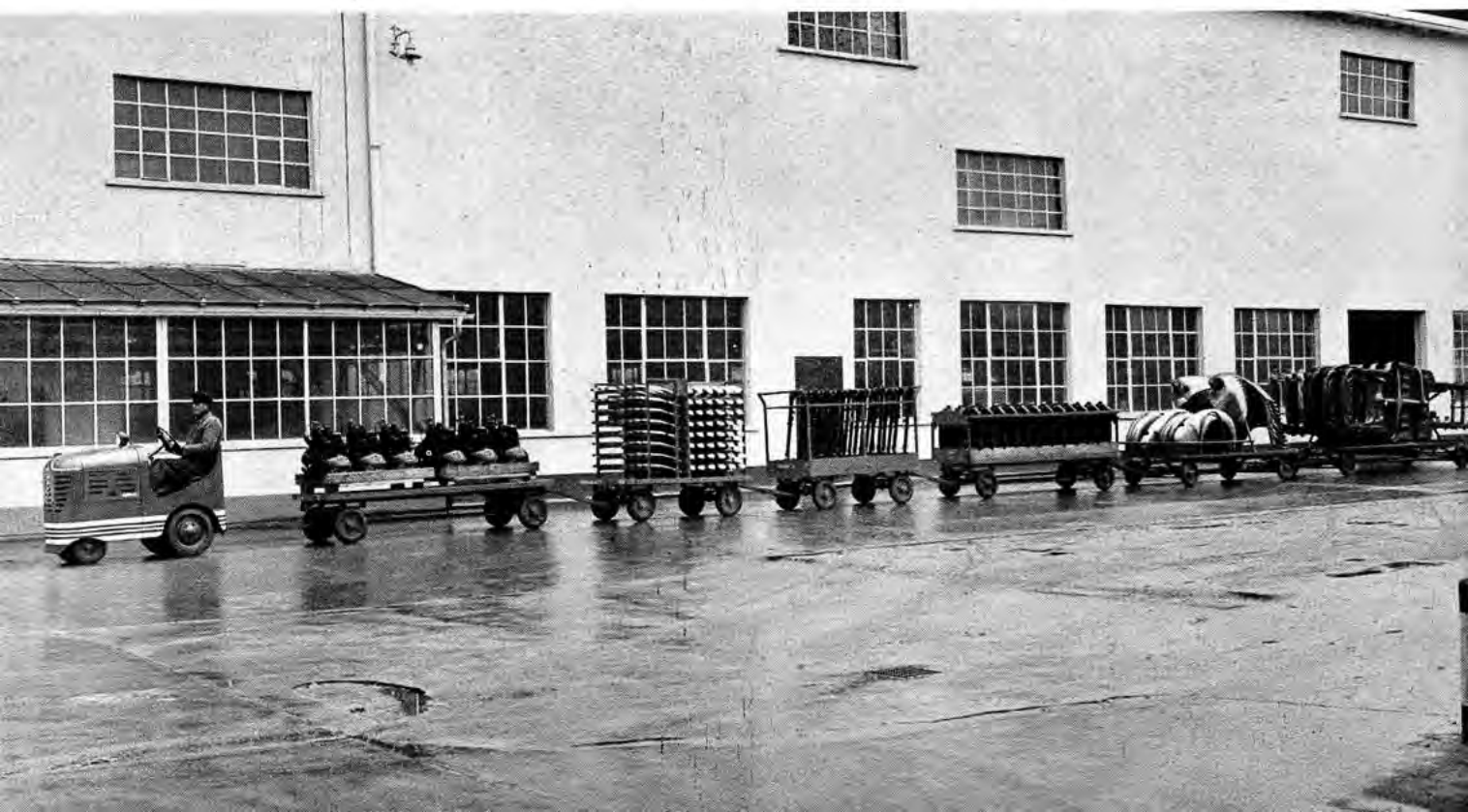
Neuzeitliche Zugmaschine und Plattformwagen mit Spezialaufbauten für CKD-Teile.
