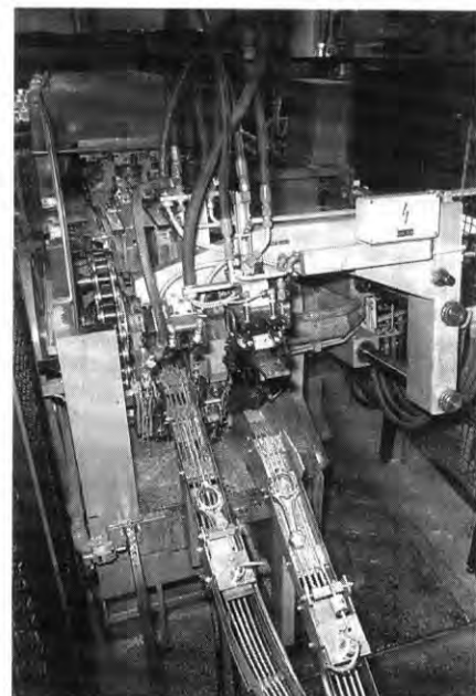
Die Pleuefertigung für die Motorfamilie II ist zu 90 Prozent verkettet; an drei Stellen wird das Teil jedoch noch von Hand in die Maschine eingelegt. Auf dem Bild ist die automatische Entladeeinrichtung der Klink-Räummaschine zu erkennen.
