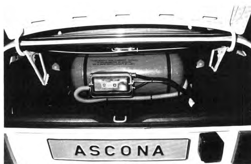
Ein in unserem Ascona eingebauter Opel-Flüssiggastank.
