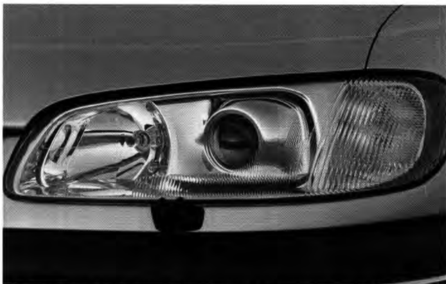
Highlight: Das neue Xenon-Scheinwerfersystem bietet eine deutlich größere Reichweite
