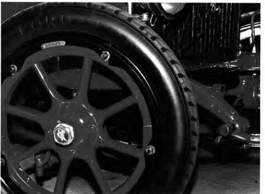
Akademisch: Die Kombination von Holzspeichen, Stahlbett und Schlauchreifen beim 4/8 PS-Opel
