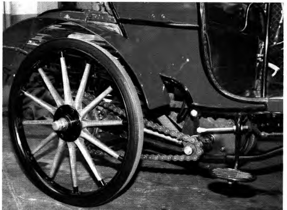
Wichtig: Die Kraftübertragung per Kette – wie hier beim Lutzmann – hatte sich bald überlebt
