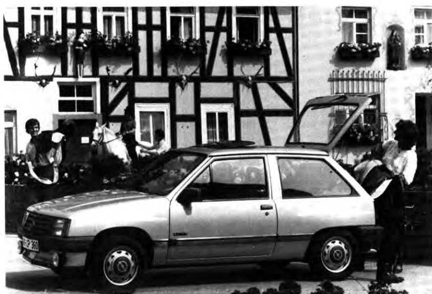
In den Corsa paßt nicht nur viel Gepäck, sondern es geht auch leicht hinein. Damen werden die niedrige Ladekante und den großen Öffnungswinkel der Hecktür schätzen; nach dem Umdrehen des Schlüssels öffnet eine Gasdruckfeder die Hecktür selbsttätig (Abbildung Luxus-Version).
