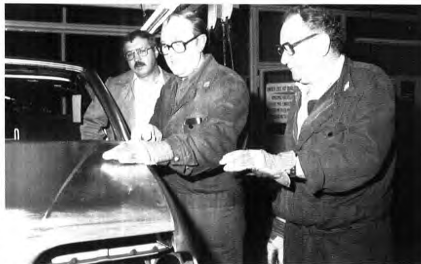
„Pate“ G. Bach (rechts) demonstriert Mitarbeiter R. Rotzeck die richtige Handhaltung beim Schleifen einer Rohkarosserie. Im Hintergrund Anlernmeister Th. Wagner.
