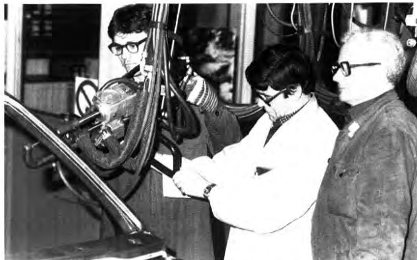
Mit Unterstützung von Meister W. Schnur (rechts) erlernt Mitarbeiter R. Krüger das Punktschweißen an der Vordersäule.
