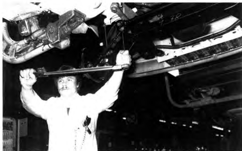
Drehmomentkontrolle an der Befestigung-Vorderachse in der Wagenendmontage durch Mitarbeiter Klaus Köhr.
