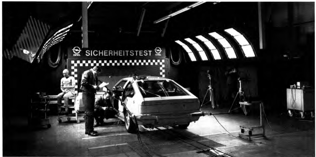
Im Opel-Sicherheitszentrum werden letzte Vorbereitungen für einen Crashtest mit einem Monza getroffen. Die hochmoderne Lichanlage leuchtet dreimal so hell wie die Mittagssonne am Mittelmeer. Hochgeschwindigkeitskameras machen beim Crashtest bis zu 20.000 Aufnahmen pro Minute, um nachträglich eine genaue Auswertung des Crashverhaltens zu ermöglichen.
