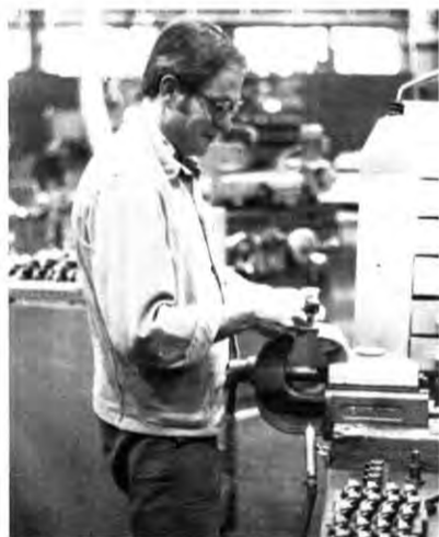
Links Mitarbeiter Bernward Dahlberger beim Neubestücken von Innenfräsern. Die Werkzeuge sind in der Kurbelwellenfertigung eingesetzt. — Rechts Mitarbeiter Werner Schindler beim Einstellen von Gewindestrehlern. Die Werkzeuge sind in der Fertigung Bolzen-Radlager für Kadett und Ascona im Einsatz.
