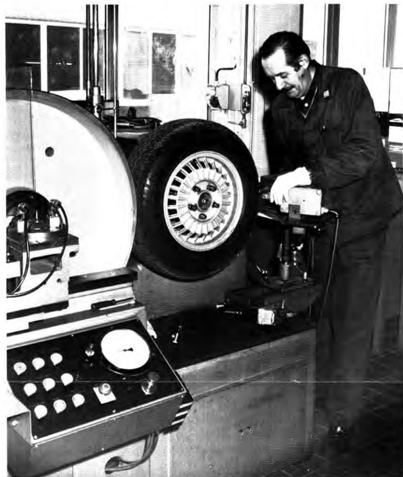
Unser Arbeitsplatzporträt zeigt Mitarbeiter Georg Cezanne beim Rundlaufvermessen von Versuchsreifen in der PEK-Werkstatt.
