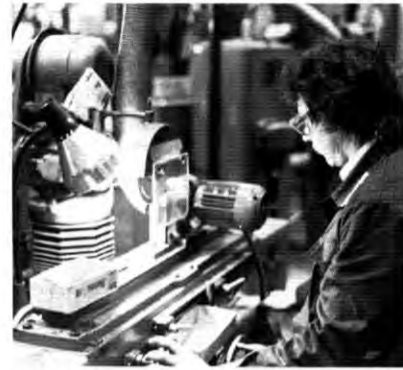
Mitarbeiter Wolfgang Lösch beim Schleifen von Wig-Elektroden.
