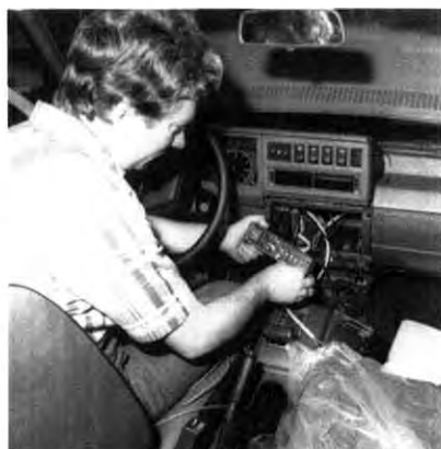
Mitarbeiter Bernhard Czepelka beim Einbau der Funkanlage in ein Spezialfahrzeug der Feuerwehr.
