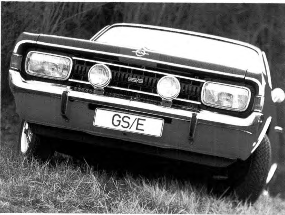
Nix Hosenträger: Mit Benzineinspritzung und 150 PS kratzte der GS/E an der 200 km/h-Marke
