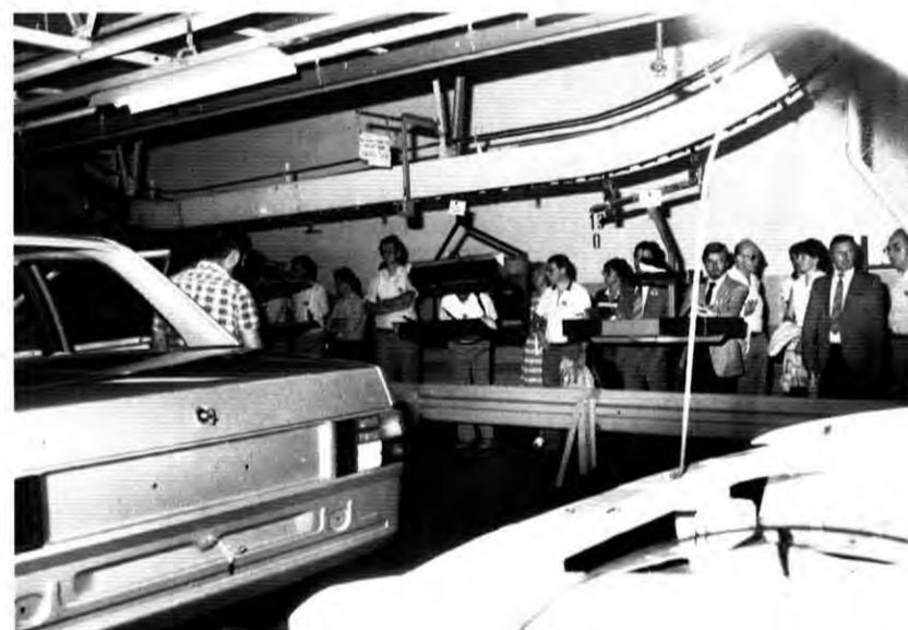
Am Band der Karosserie-Fertigmontage: die bereits fertig lackierten Karosserien kommen angeschwebt und werden hier von Station zu Station vervollständigt.
