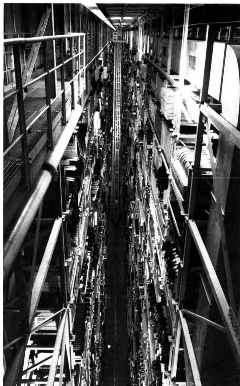
Blick in eine Regalgasse: in der Mitte einer der riesigen Krane, ein Regalförderfahrzeug („RFZ“), von denen jedes für eine der zehn Gassen zuständig ist. Es nimmt die Paletten auf und bringt sie an das vom Prozeßrechner angewiesene Fach, wo die Teile bis zum Abruf eingelagert werden.
