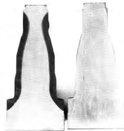
Ein Bauteil: links induktiv-gehärtet, rechts ungehärtet.
