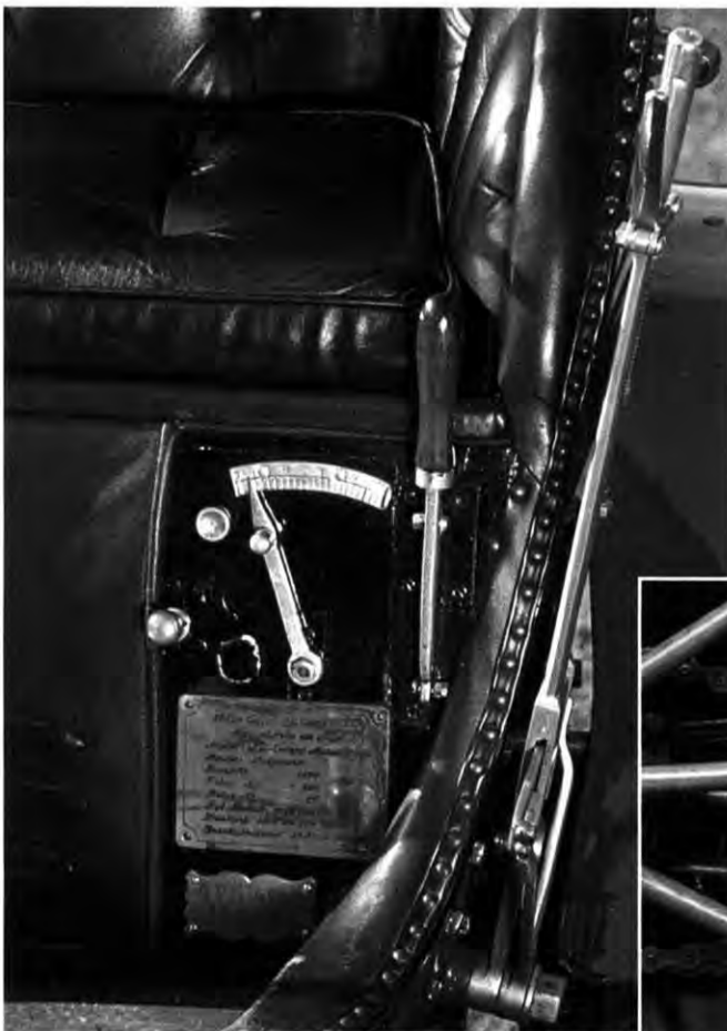
Patent: Handbremse, Gashebel und Zündverstellungs-Anzeige sitzen dicht beieinander – die Kraftübertragung erfolgt per Kette
