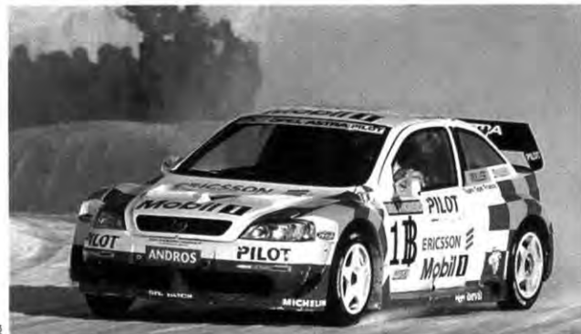
Mit zwei Exemplaren eines vollständig neu entwickelten Astra V6 4x4 ergänzt das Opel Team France seinen Fuhrpark bei den populären Eisrennen um die Andros-Trophy in Frankreich. Die Astra verfügen über einen 3,3-Liter-V6-Motor mit 430 PS, über Allrad-Antrieb und Allrad-Lenkung. Pilotiert werden die beiden „Eis-Astra“ von Titelverteidiger Yvan Müller, Marrku Aien, Dany Snobeck und James Ruffier.
