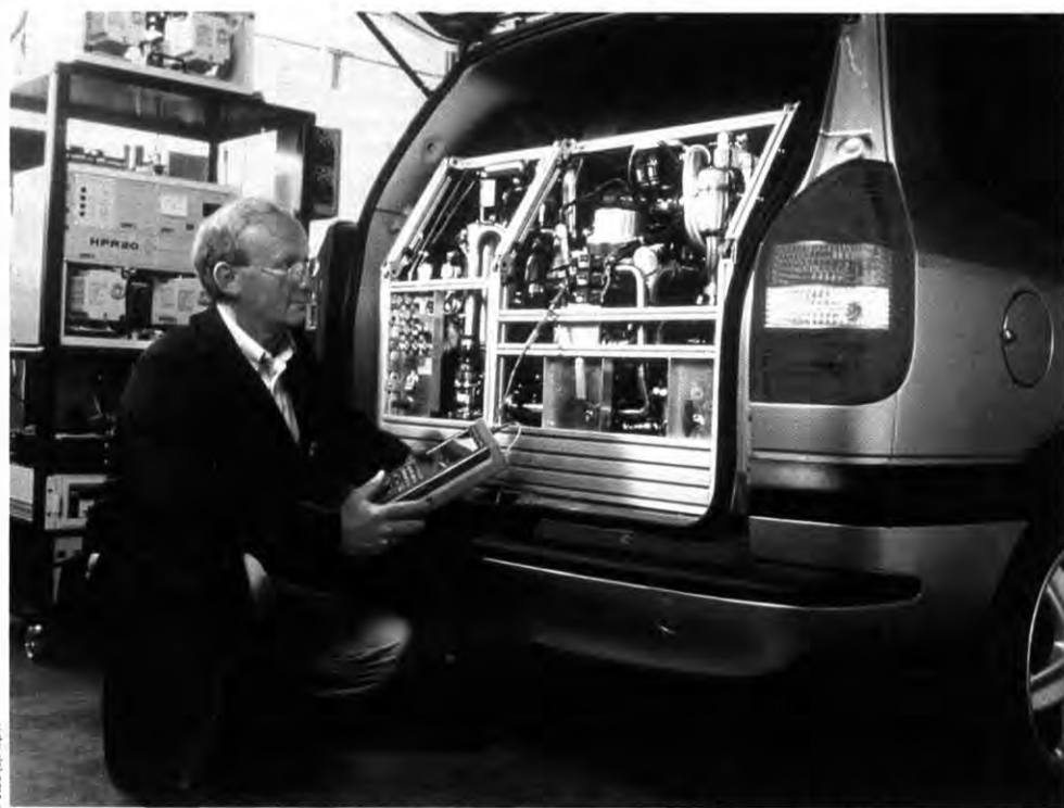
Versuchsträger: Beim Konzept-Fahrzeug auf Zafira-Basis ist die Technik im Heck untergebracht
