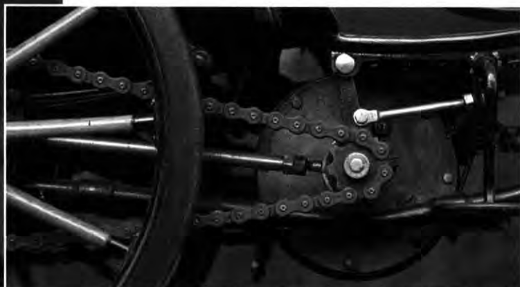
Patent: Handbremse, Gashebel und Zündverstellungs-Anzeige sitzen dicht beieinander – die Kraftübertragung erfolgt per Kette
