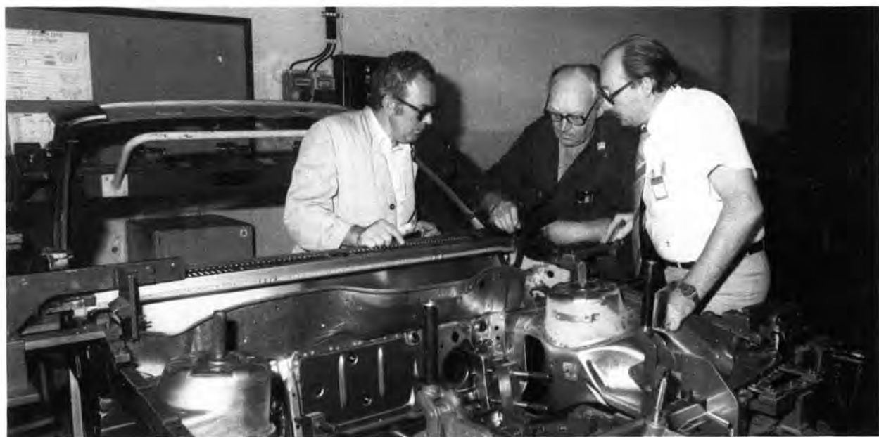
Die Produktion muß „geprobt“ werden: Begutachtung des Zusammenbaues Front an der Kontrollvorrichtung des Pilotbandes durch Obermeister Walter Grimm, Inspektion, Inspektor Erich Breuer sowie Mitarbeiter Rudolf Daum, Produktionsvorbereitung-Zusammenbau (von links).
