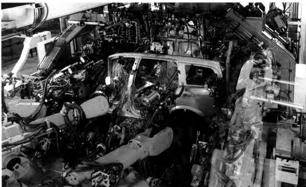
Höchste Präzision: Die „Preciflex“-Schweißanlage fügt in einer Station die Rohkarosse zusammen
