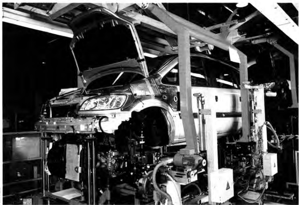
In Treue fest: Am laufenden Band werden Karosserie und Chassis automatisch verbunden
