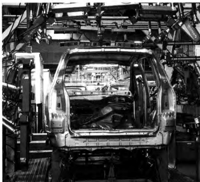
Genau hingeguckt: Per Laser werden die Karosserien vermessen
