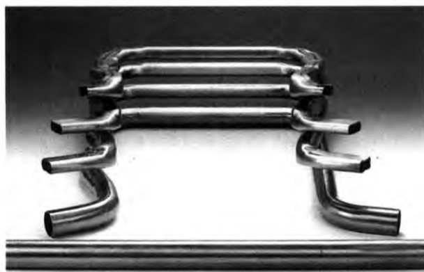
Wasser marsch: Vorderachsträger durch Hydroforming
