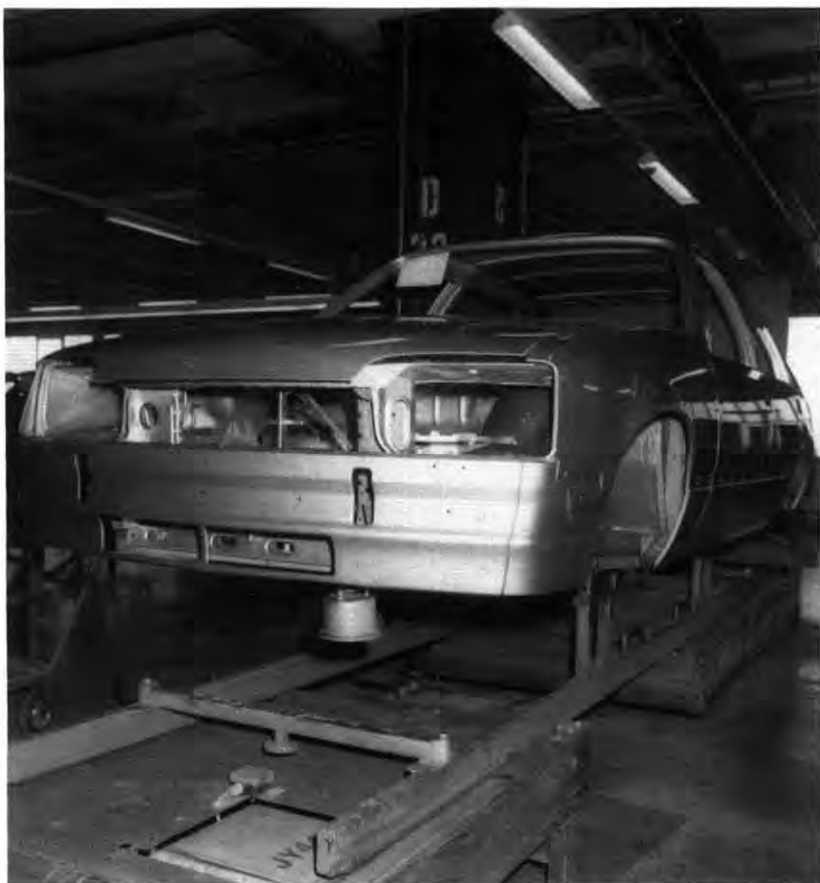
Auf dem Foto erkennt man deutlich den an der Frontleiste der Karosserie angebrachten SICARID-Topf, der sich hier gerade über dem Lesegerät, sichtbar am unteren Bildrand, befindet.
