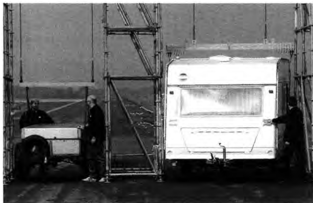
Rohe Kräfte: Charakteristisches Schlingern im Pendelversuch
