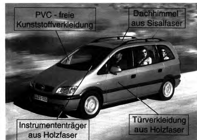
Feldversuch: Sisal- und Holzfasern ersetzen Kunststoffe
