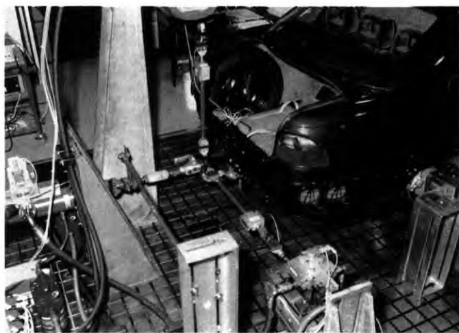
Kraftakt: Auf dem Prüfstand werden horizontale und vertikale Belastungen gemessen
