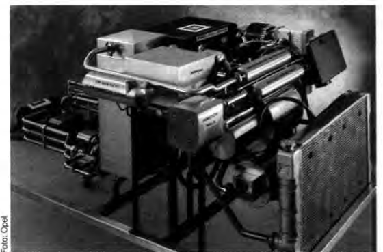
Reformer: Aus Benzin wird Wasserstoff erzeugt
