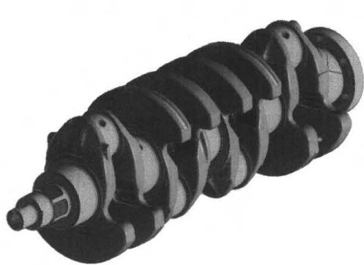
Konstruieren: Am Anfang steht, wie bei dieser Kurbelwelle, der CAD-Entwurf der einzelnen Antriebs-Komponenten
